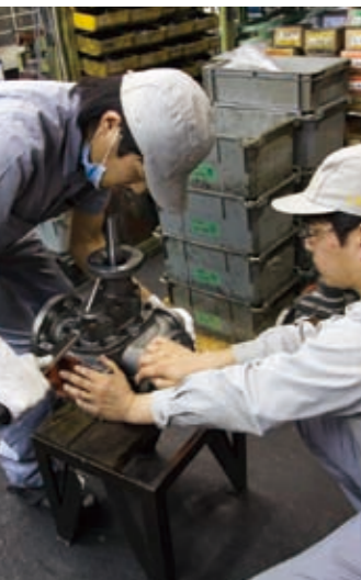
精度の高い組立を経験豊富な技術者が丁寧に進める。設計者が立ち会いのもと、ねじを締める強度まで数値化して記録する場合もある。
